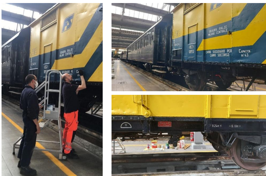
Figura 9 – Realizzazione delle marcature sul Carro Sussidiario del Carro Soccorso
