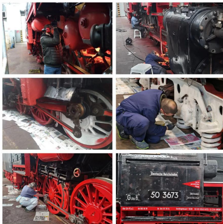
Figura 5 – Lavori di ripristino della livrea sulla locomotiva ex DR 50 3673
